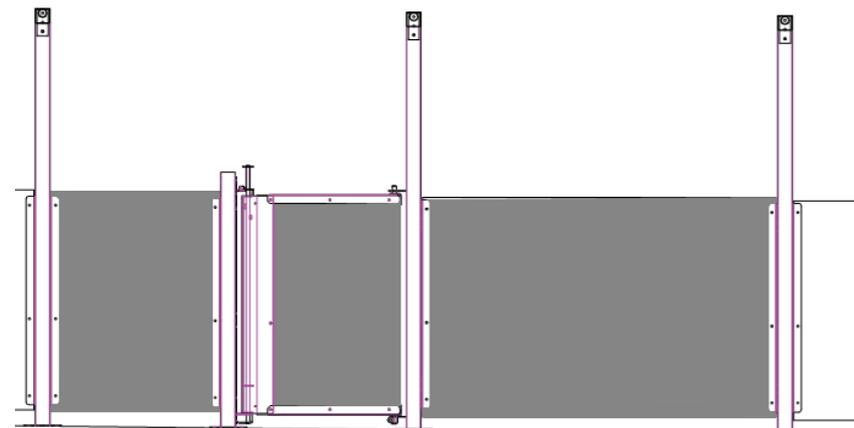
Construction Mécano-soudé - Acier Qualité S235 - Finition Galvanisation à Chaud suivant norme EN ISO 1461 2009
