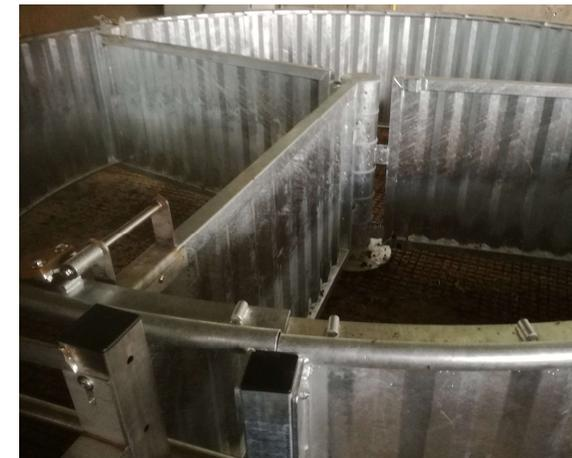
Construction Mécano-soudé - Acier Qualité S235 - Finition Galvanisation à Chaud suivant norme EN ISO 1461 2009
